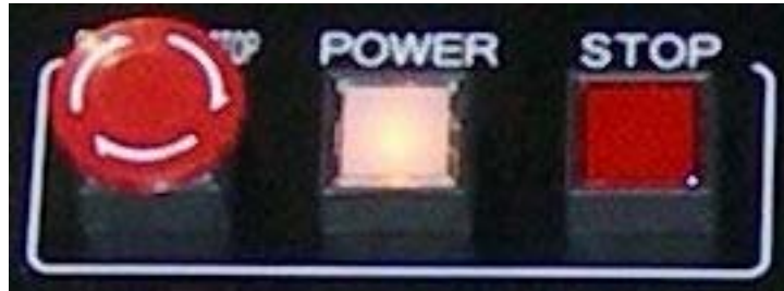
Abbildung 1: Einschalten des PC70 mit Hilfe der POWER- Taste (mittlere Taste im Bedienfeld)
